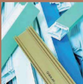
Les chutes de profilés qui résultent de la production de fenêtres PVC ainsi que le PVC des vieilles fenêtres sont rassemblés (illustration de gauche). Grâce à un processus de co-extrusion, de nouveaux profilés avec une base en matière recyclée sont fabriqués (illustration de droite).
